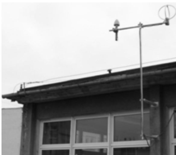
Ryc. 6. Antena stacji systemu Linet w Katedrze Elektrotechniki i Elektroenergetyki AGH w Krakowie (Zdj.: Sz. Moskwa)
